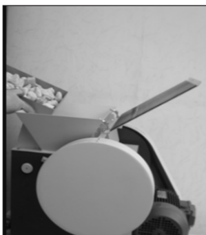
Рис. 6. Дроблення щебеню на щековій дробарці марки ПЦД 10
